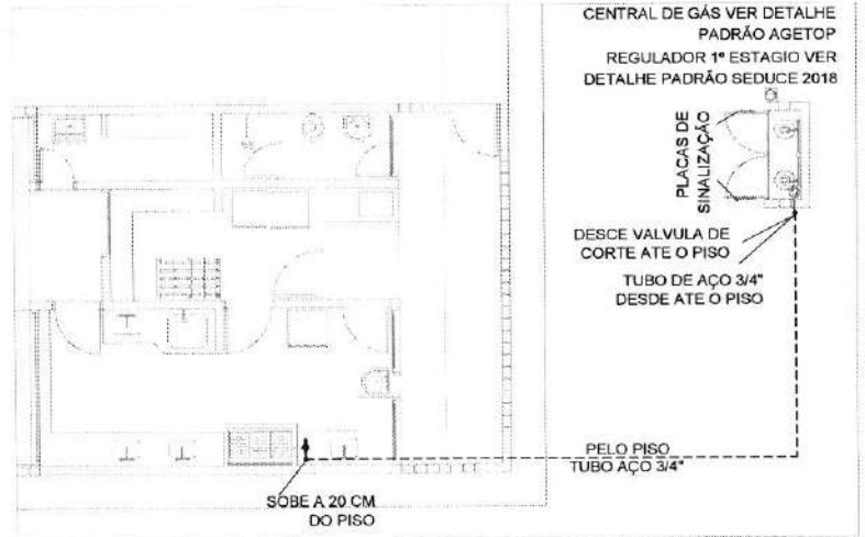
Planta baixa - Instalação de Gás Escala 1:100
